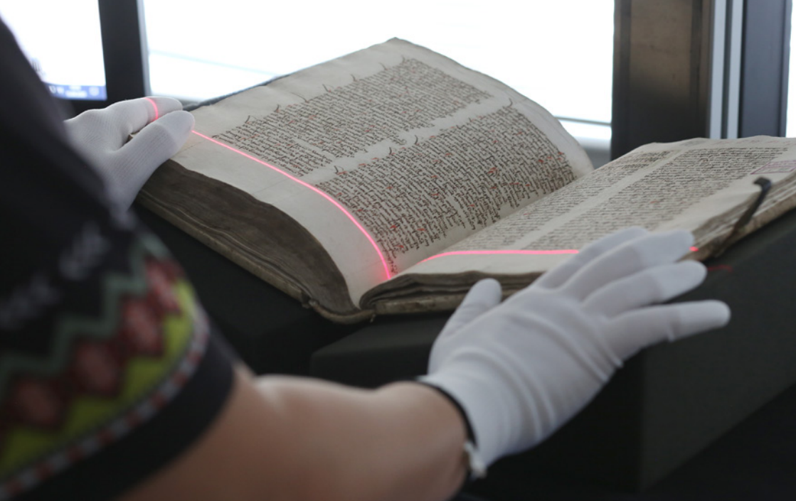
Abb. 6: Einsatz eines buchschonenden V-Scanners bei der Digitalisierung
