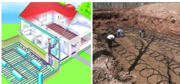
Ενδοδαπέδια θέρμανση με γεωθερμία
